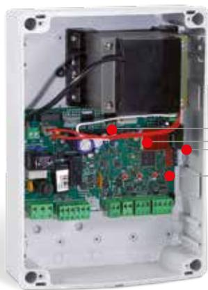
**afficheur à deux chiffres et boutons de navigation** pour faciliter la configuration et le diagnostic
